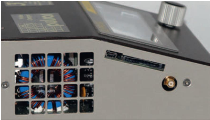
W lewej części obudowy znajduje się gniazdo USB, slot karty-SD i opcjonalnie - gniazdo anteny Bluetooth.
