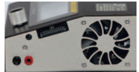
Po prawej stronie obudowy znajdują się podłączenia do pakietu, balansowania, czujnika temperatury oraz wentylator
